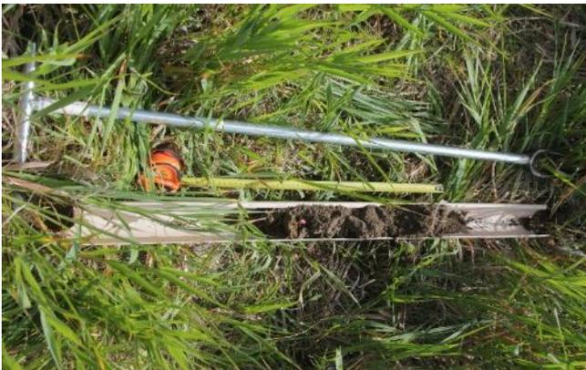
Matériel nécessaire au sondage : tarière pédologique, mètre, gouttière.
