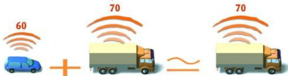
Figure 5 : Niveau sonore de 2 sources d'intensité différentes (source : www.bruitparif.fr)
