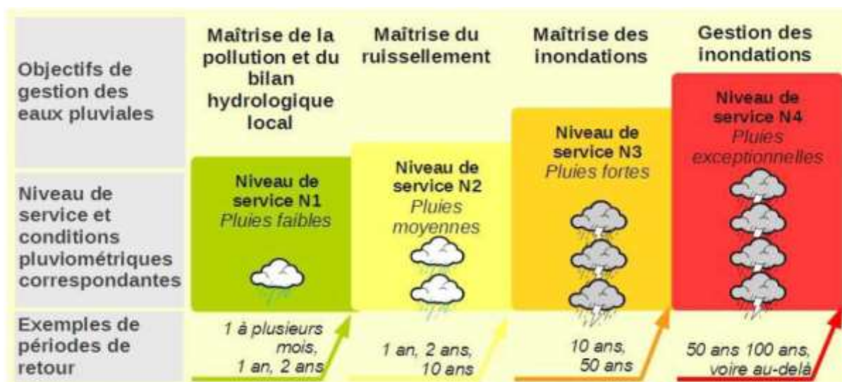
Représentation des niveaux de service, adapté de "la ville et son assainissement".
