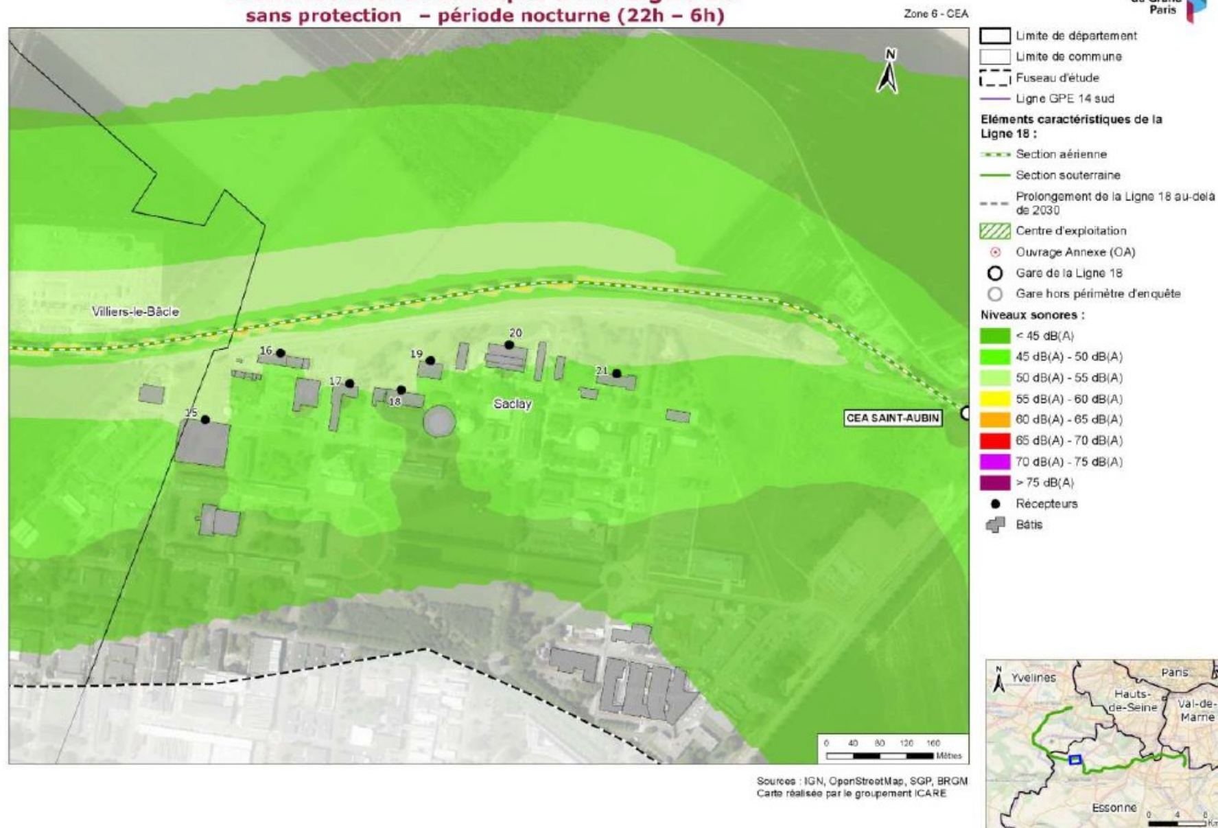
Illustration 30: Carte contribution acoustique de la ligne 18 (source : compléments apportés par la Société du Grand Paris suite à l'avis du 21 février 2018 de l'autorité Environnementale, pièce du dossier de l'enquête publique préalable à l'autorisation environnemental)
